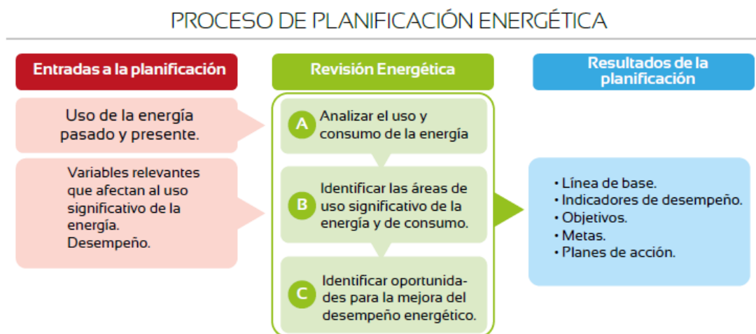
Figura 3.- Proceso general de la Planificación Energética.(Fuente: EnerAgen)
